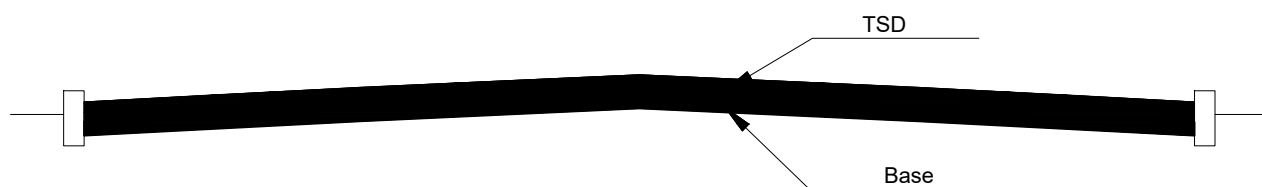
Fig. 4 PAVIMENTAÇÃO EM TSD - SEÇÃO TIPO DAS RUAS
