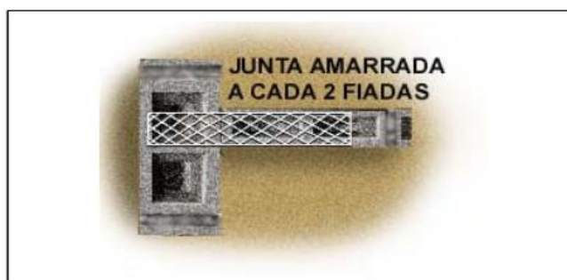
Figura 7: Junta com tela de aço entre alvenarias
