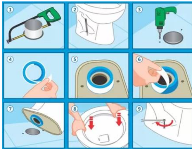
Figura 23: Processo de fixação das bacias sanitárias.
