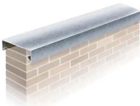
Figura 11: Execução do chapim finalizada
