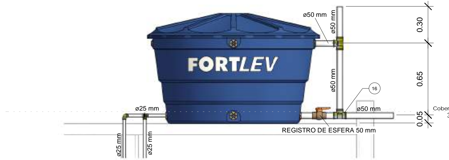
2 DETALHAMENTO DA CAIXA D'ÁGUA 1 : 20
