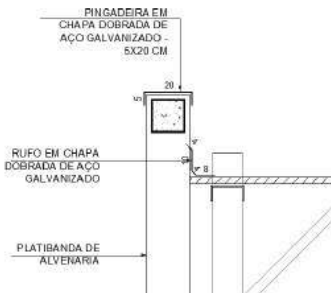
Figura 13 – imagem exemplificativa de detalhe de rufo/alvenaria e pingadeira
