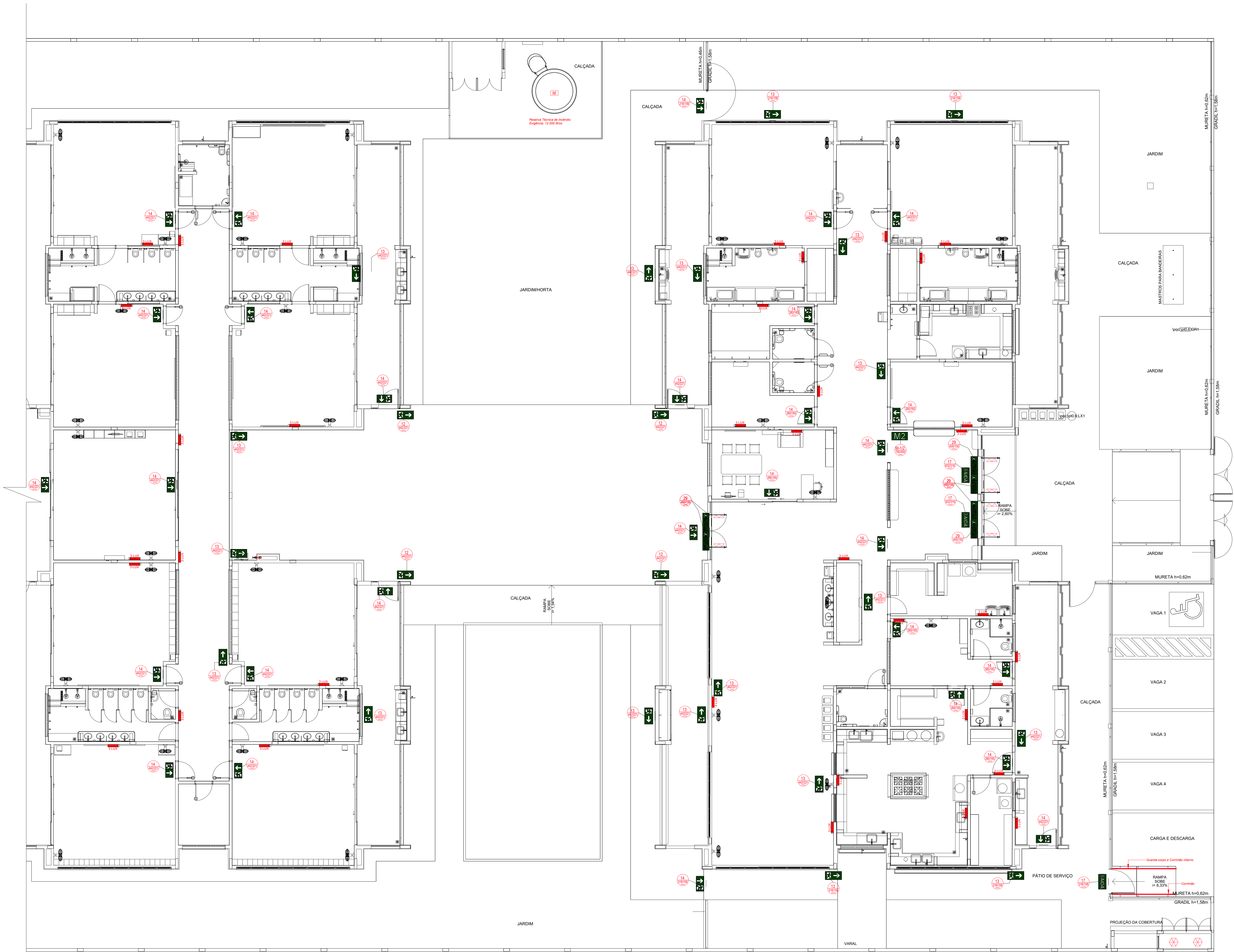
1 PLANTA BAIXA - SINALIZAÇÃO E ILUMINAÇÃO ESCALA 1/75
