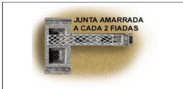
Figura 7: Junta com tela de aço entre alvenarias
