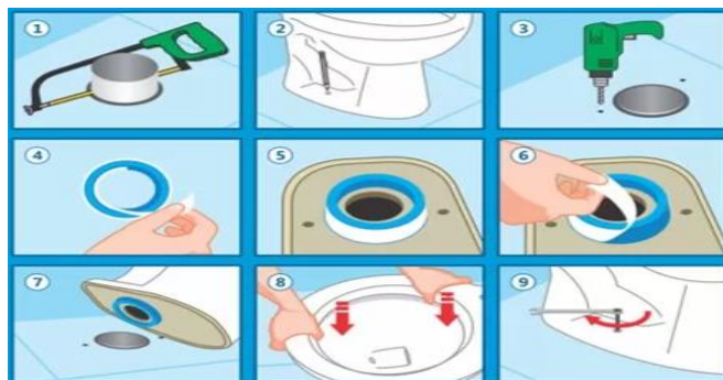
Figura 23: Processo de fixação das bacias sanitárias.
