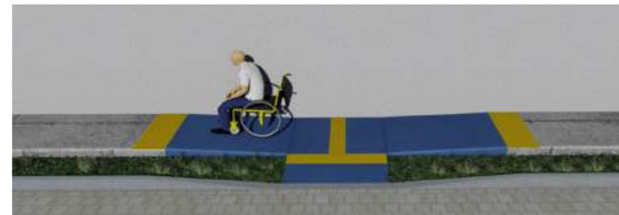
Persp. ilustrativa - Rampa estreita com canteiros
