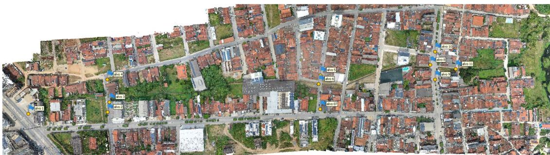
Figura 3-2 – Distribuição dos pontos de controle e verificação na área do levantamento
