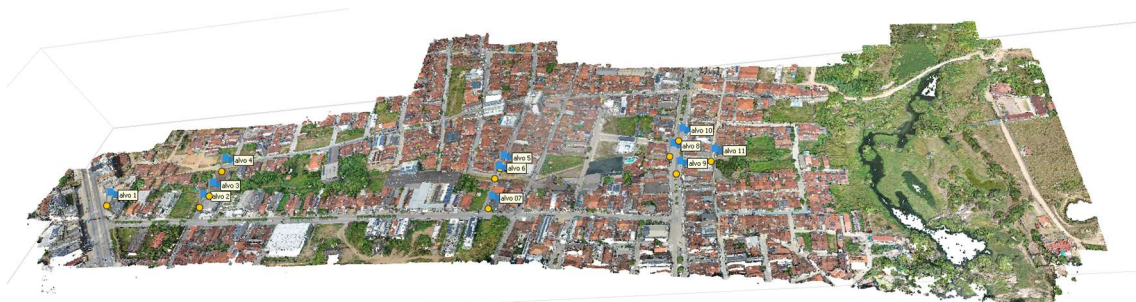
Figura 3-7 – Nuvem densa de pontos obtida no processamento fotogramétrico
