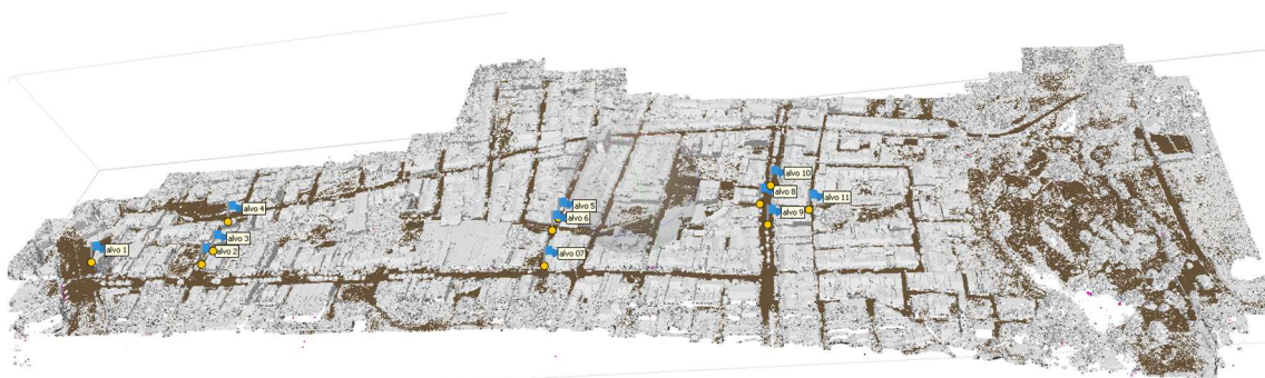
Figura 3-8 – Classificação dos pontos representativos do terreno
