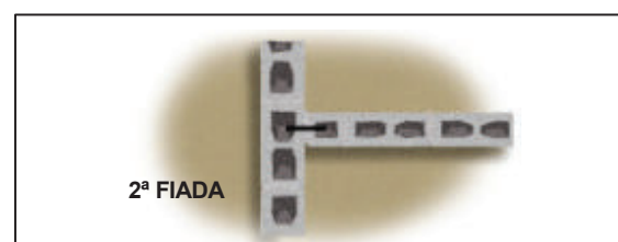
Figura 11. Amarração com Grampos – 2ª Fiada
