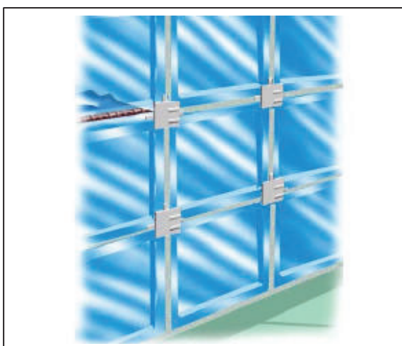
Figura 22. Blocos de Vidro com lance de Vergalhão
