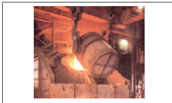
Figura 27. Convertedor LD
