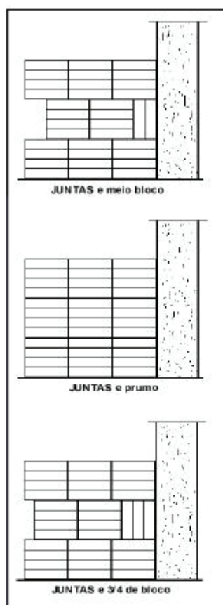
Figura 46. Tipos de Juntas entre Fiadas de Bloco
