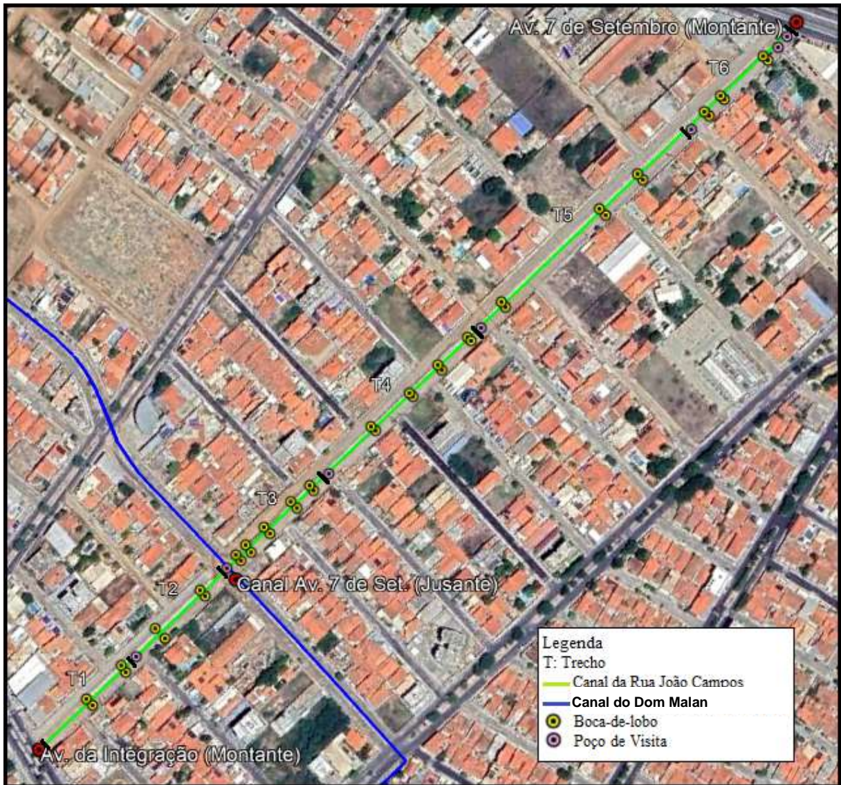
Figura 73 – Canal da Av. João Campos (microdrenagem).
