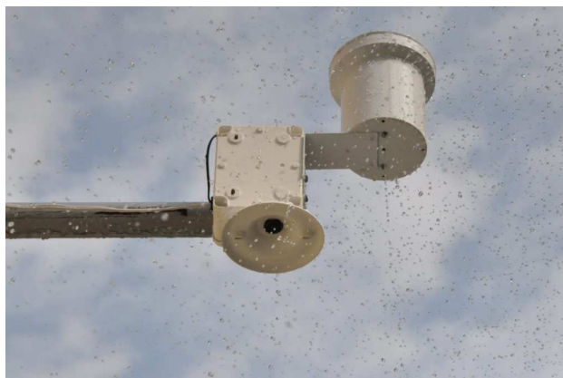
Figura 37 - Sensores de nível de alagamentos em logradouros.
