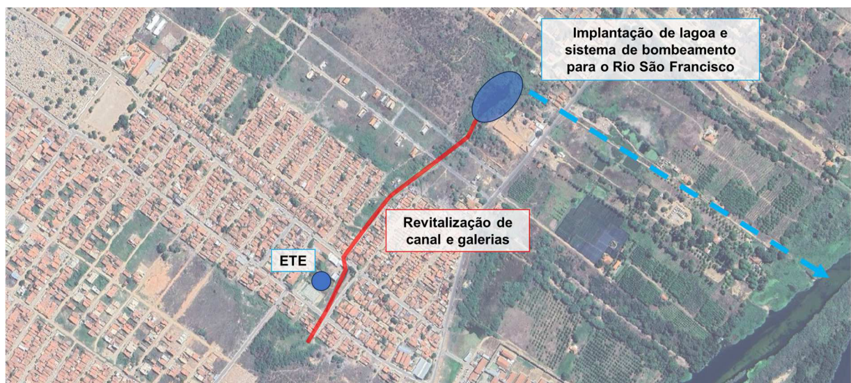
Figura 29. Revitalização de calha de canal e de galerias subterrâneas, e implantação de lagoa no Bairro Henrique Leite
