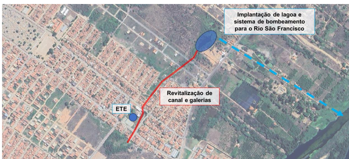
Figura 67. Revitalização de calha de canal e de galerias subterrâneas, e implantação de lagoa no Bairro Henrique Leite
