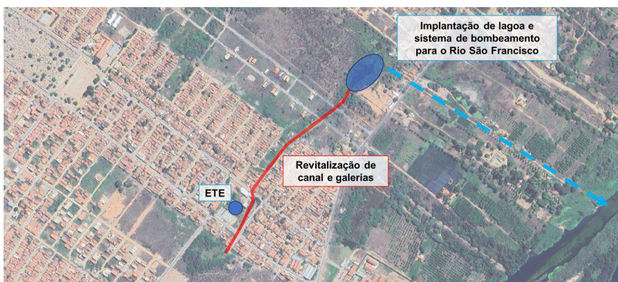
Figura 144. Revitalização de calha de canal e de galerias subterrâneas, e implantação de lagoa no Bairro Henrique Leite
