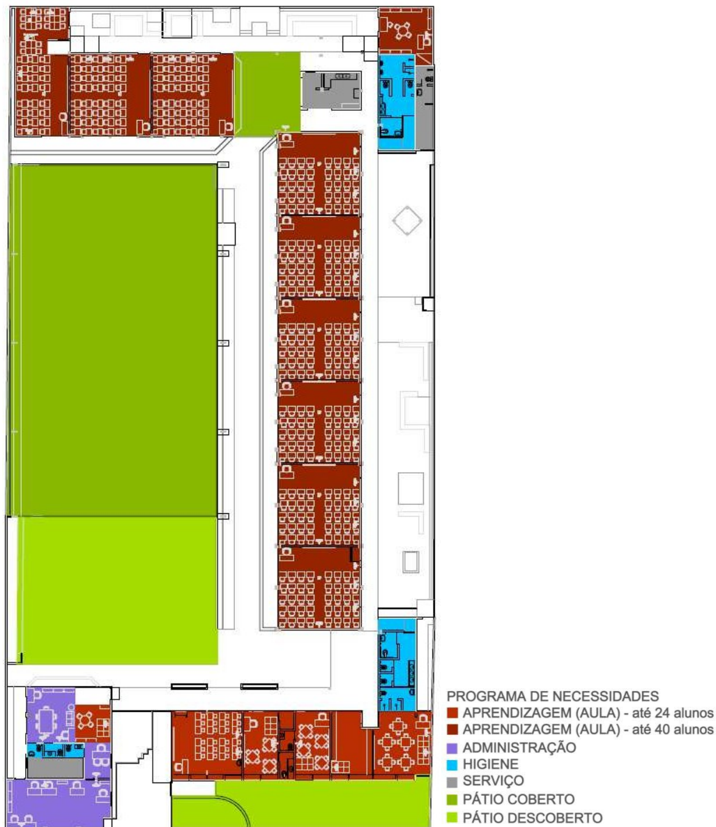
Figura 25 – PLANTA BAIXA PAV. TÉRREO - Zoneamento Proposto das funções e ambientes - Escola Parque, com cores propostas no Manual (FNDE, 2017). Fonte: autora, 2022.
