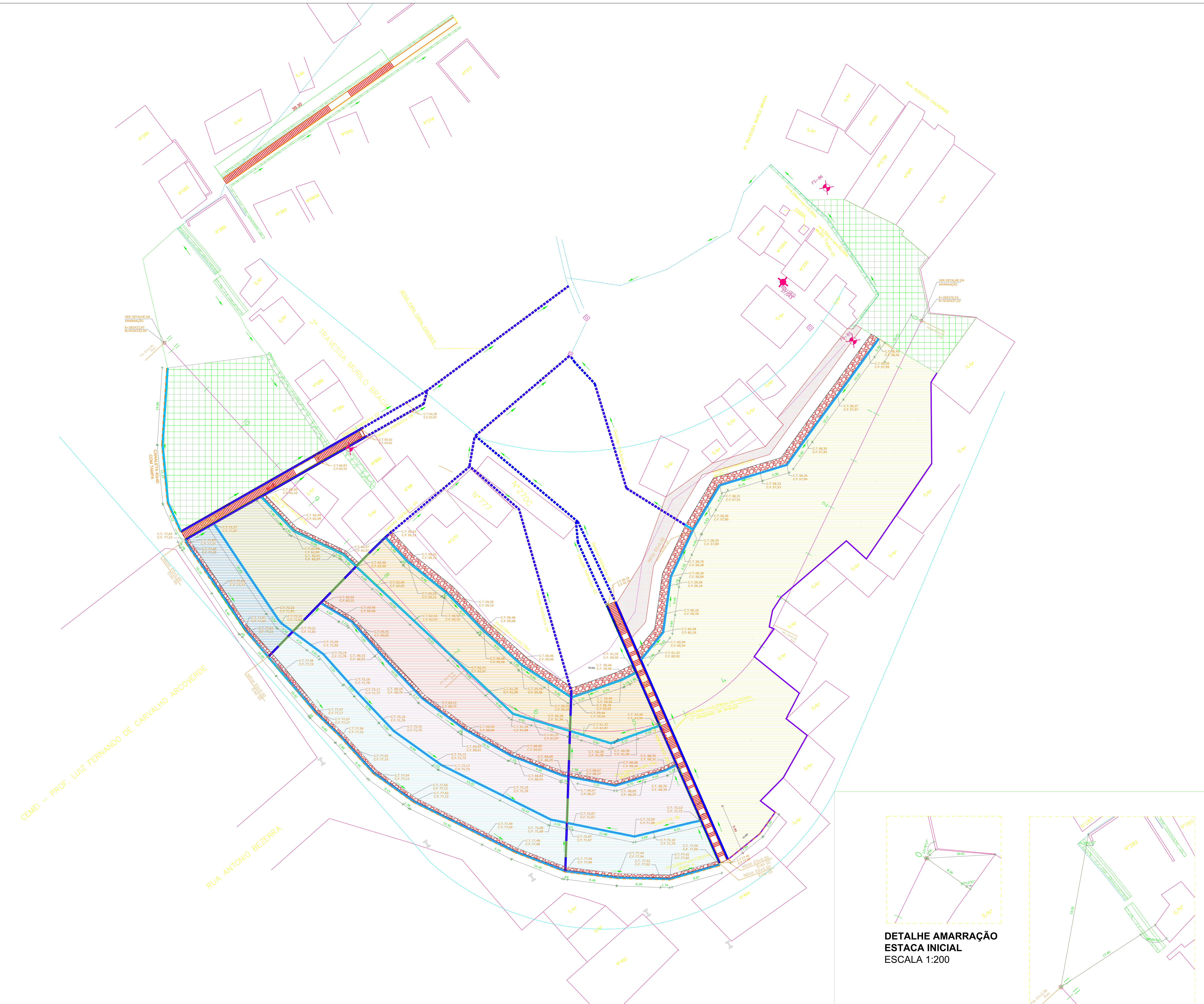
PLANTA DE CONTENÇÃO ESCALA 1:250
