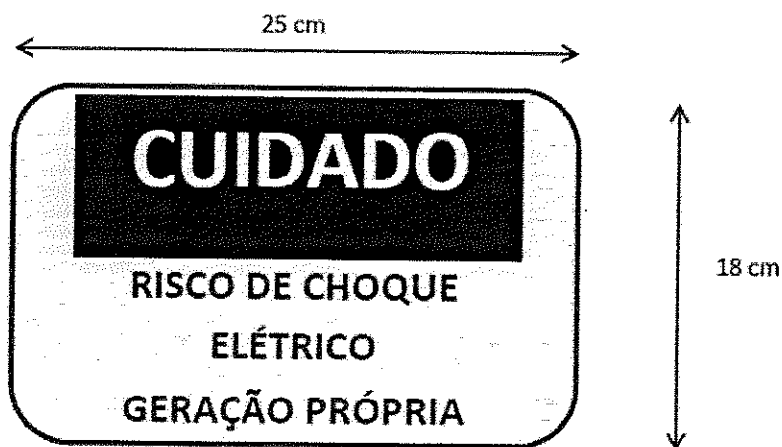
Figura 01 – Placa de advertência e sinalização de Geração Própria.
