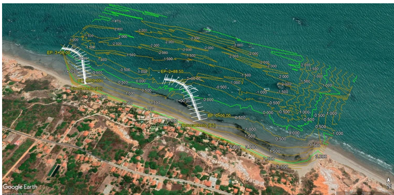
Figura 2 – Representação esquemática da alocação das estruturas dos espigões 1 e 2 e suas respectivas seções, implantadas de acordo com as curvas de nível. Praia da Peroba, Icapuí-CE.
