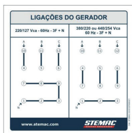
LIGAÇÕES GERADOR 3 tensões - 12 terminais Português
