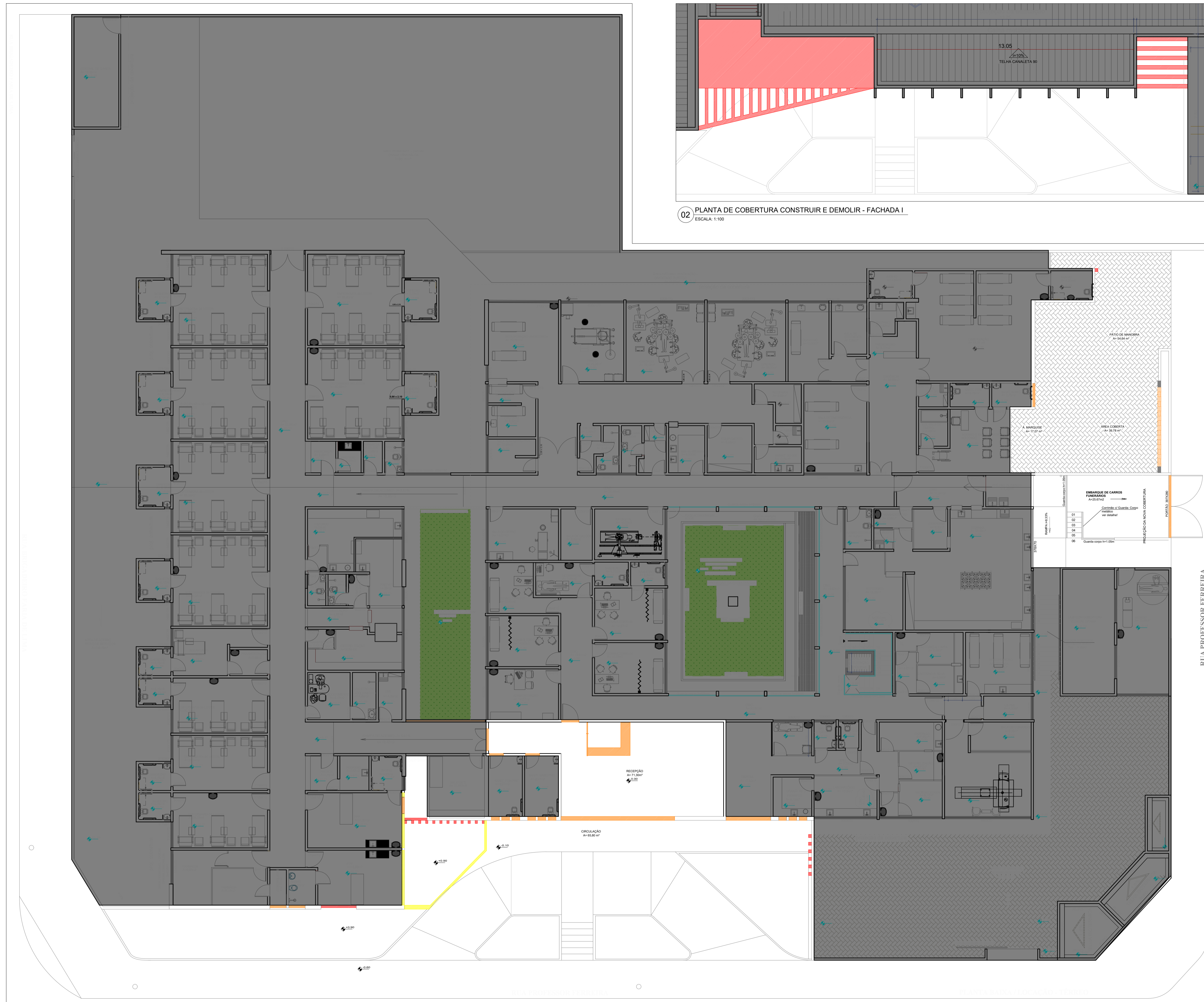
01 PLANTA BAIXA CONSTRUIR E DEMOLIR ESCALA: 1:125
