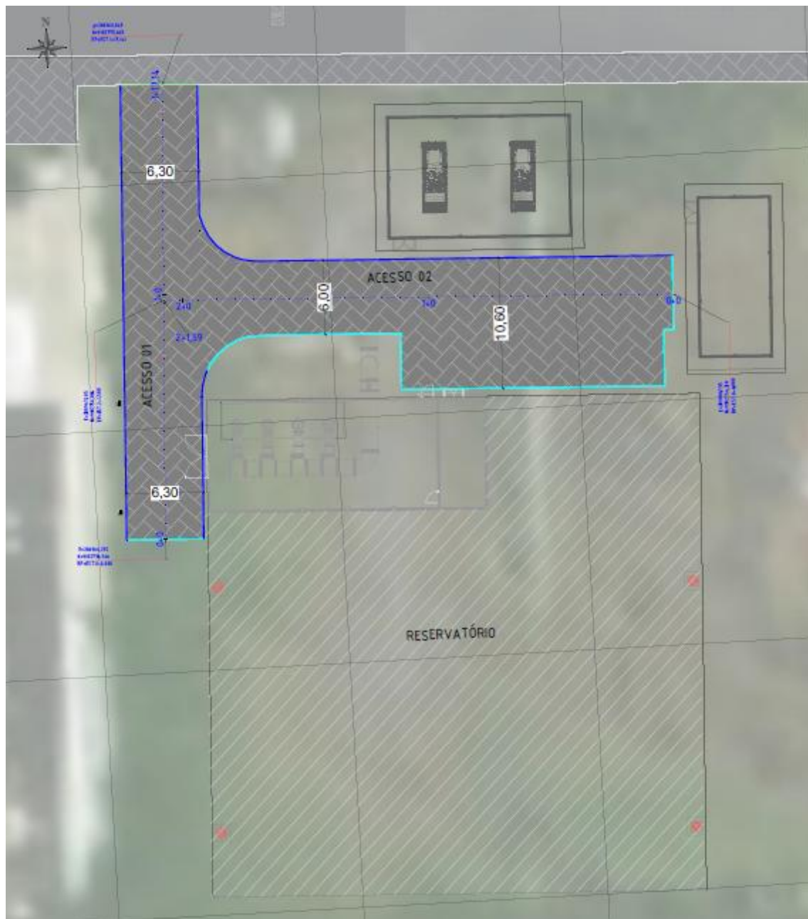
Figura 5 - Geometria dos Acessos 1 e 2 do Reservatório Sul
