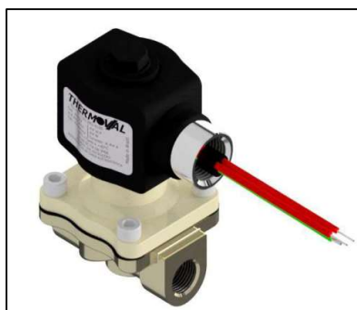
Figura: Válvula solenóide 2/2 vias ação direta NF para gás GLP
