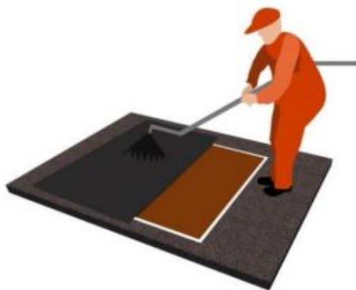
Figura 3 - Execução da Pintura de Ligação
