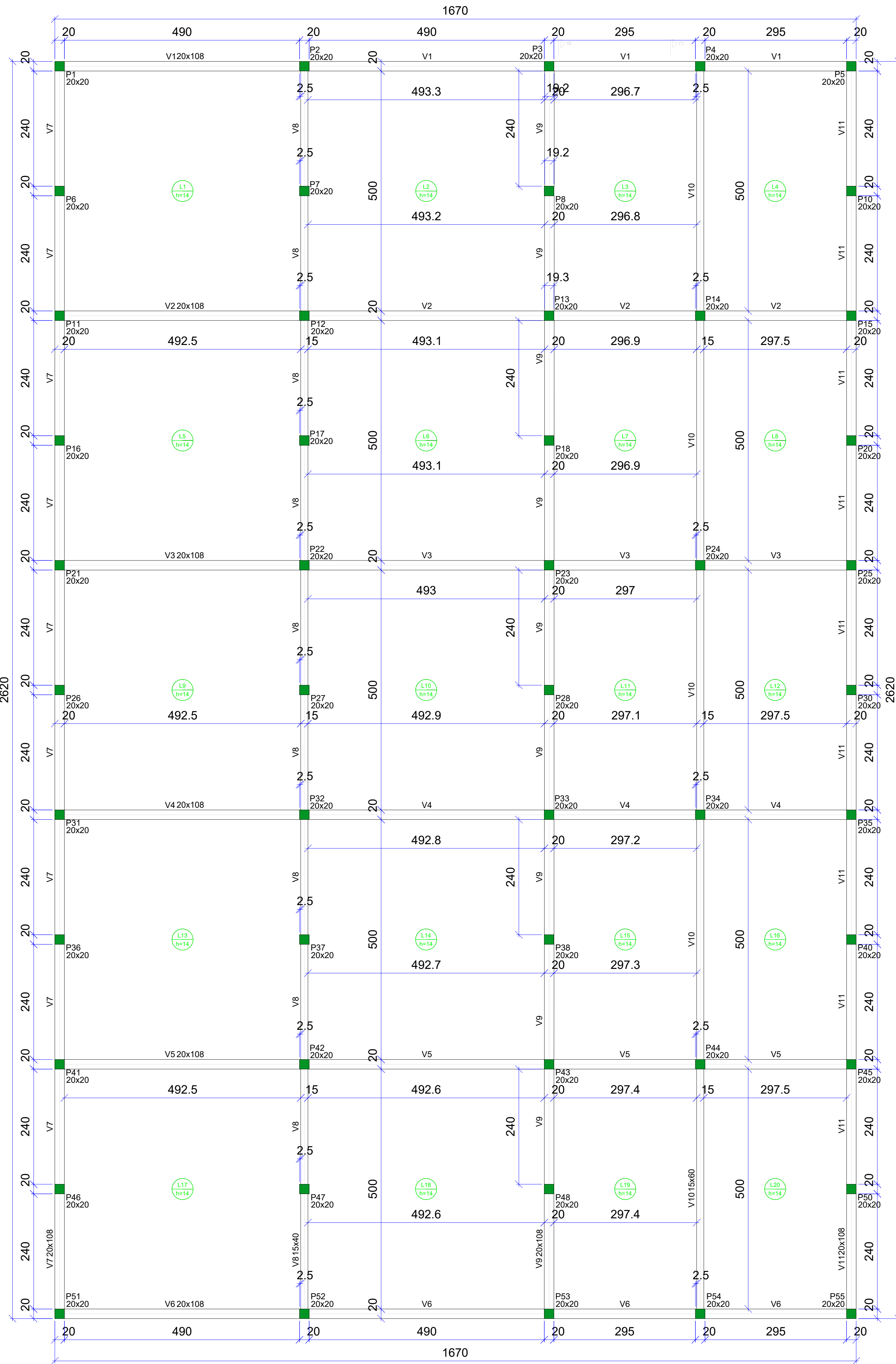
Forma do pavimento PAV.TAMPA (Nível 292) escala 1:50
