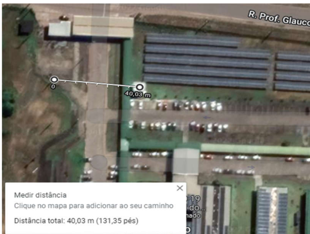
Imagem05- Distância do cubículo do trafo da usina solar a rede de distribuição em média tensão.
