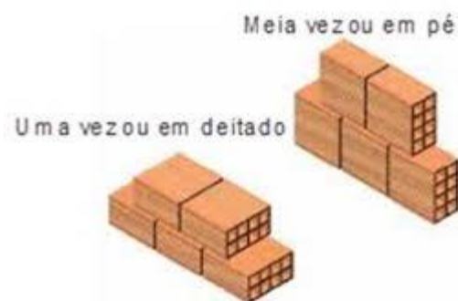
Figura 1: Detalhe assentamento de 1 /2vez.
