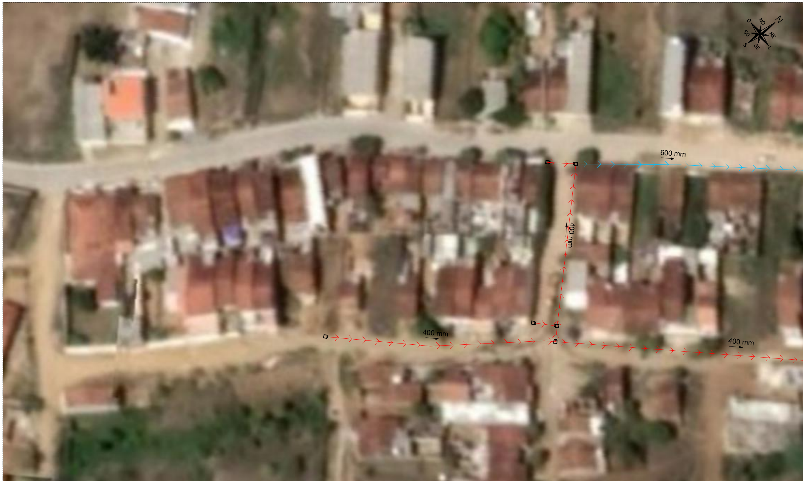
PLANTA BAIXA - TUBOS 600 e 400mm Escala 1/500
