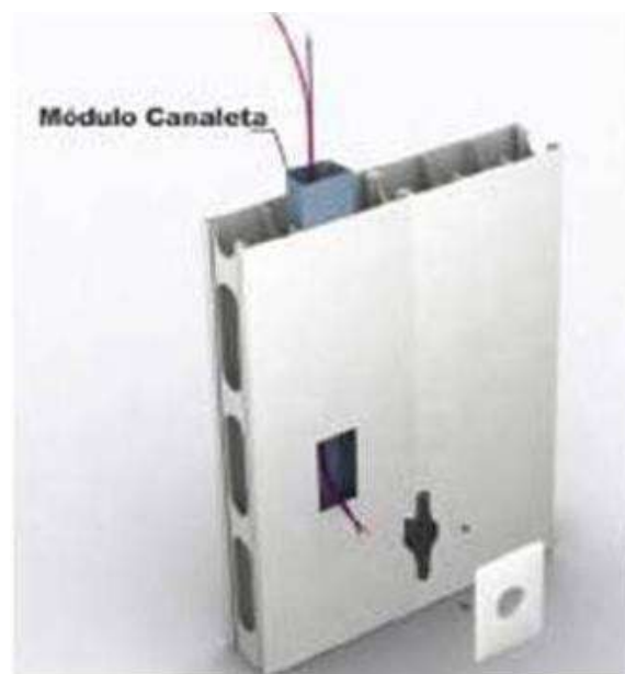
Imagem 12 - Esquema em planta do perfil canaleta dentro do módulo básico
