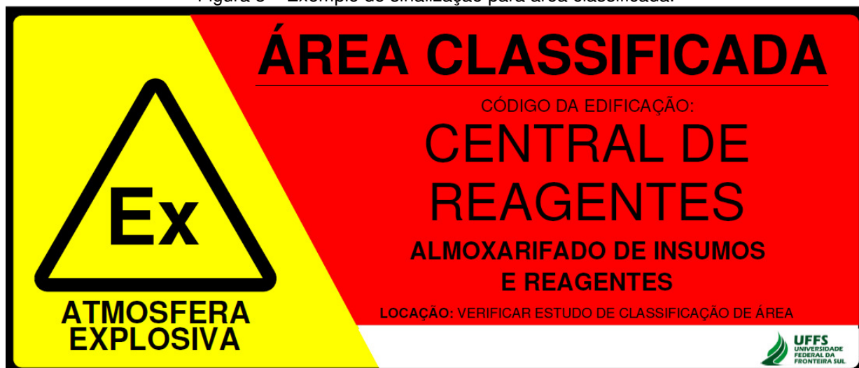
Figura 3 – Exemplo de sinalização para área classificada.
