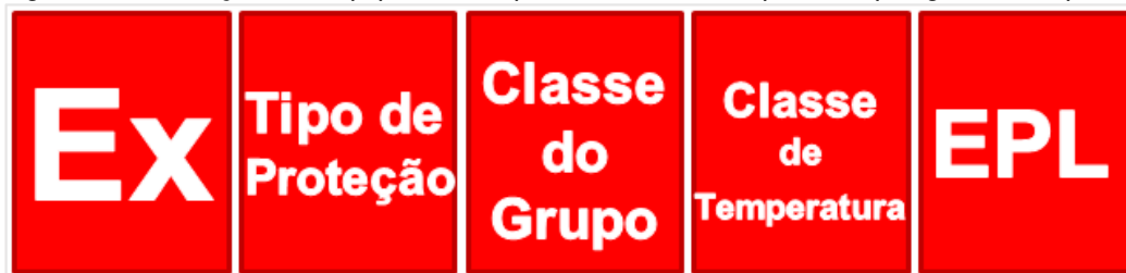
Figura 2 – Marcação em equipamentos para atmosferas explosivas por gases e vapores.
