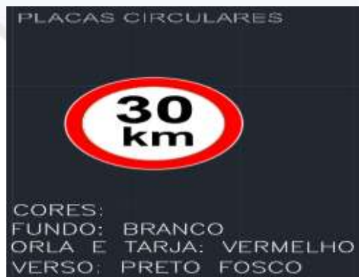
Figura 2. Placa de velocidade, com diâmetro de 60 cm.
