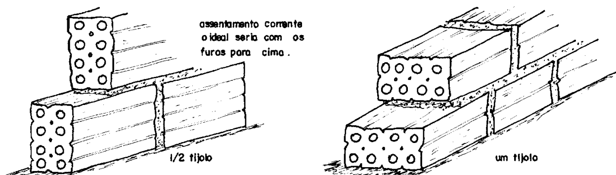
Figura 1 - Execução de alvenaria utilizando tijolos furados
