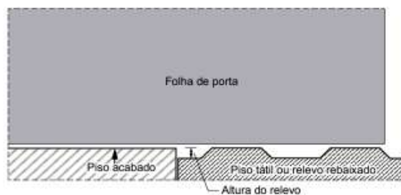
Figura 18: Detalhe do piso de ladrilho hidráulico 25x25 cm rebaixado
