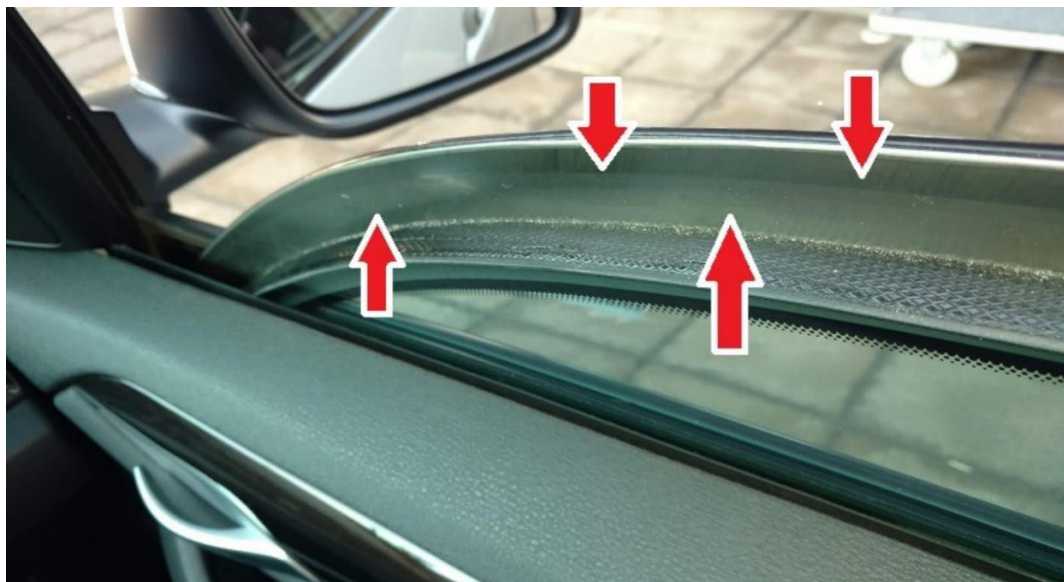
Figura 2 - Detalhe do reforço em aço na região do offset do vidro da porta dianteira
