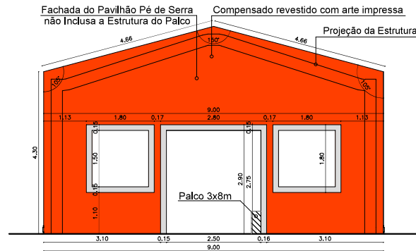
7 VISTA POSTERIOR – PAVILHÃO SALA DE REBOCO ESCALA – 1:100
