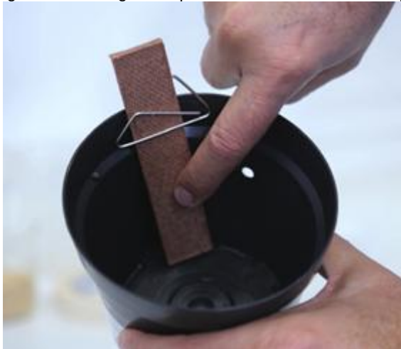
Figura 5 - Montagem da palheta na armadilha ovitrampa
