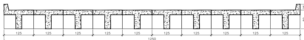
6 CORTE TRANSVERSAL - LARGURA 12,50m ESCALA 1:50
