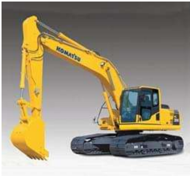
Imagem 04 – Escavadeira hidráulica 155hp
