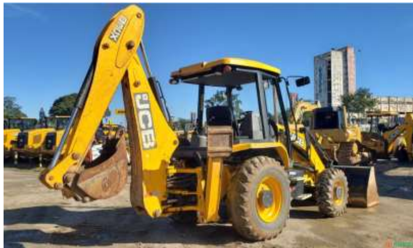
Imagem 03 – Retroescavadeira sobre rodas
