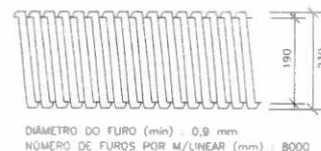
DETALHES DE TUBO DRENO CORRUGADO PEAD
