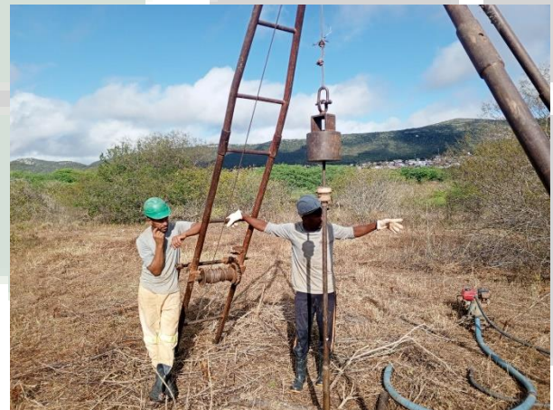
Foto 16 EXECUÇÃO DE SONDAÇÃO À PERCUSSÃO (SPT).
