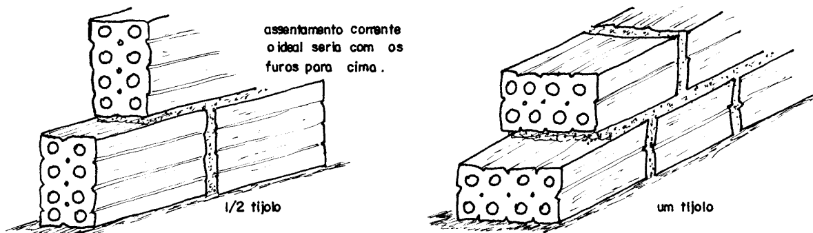
Figura 1 - Execução de alvenaria utilizando tijolos furados.
