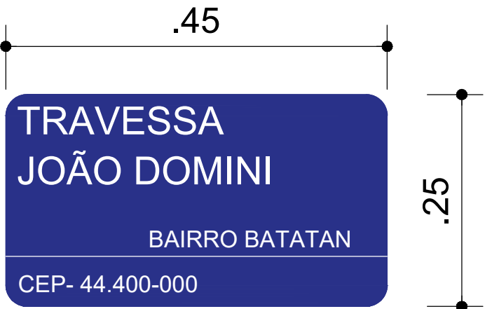
DETALHE PLACA DE INDICAÇÃO ESCALA INDETERMINADA
