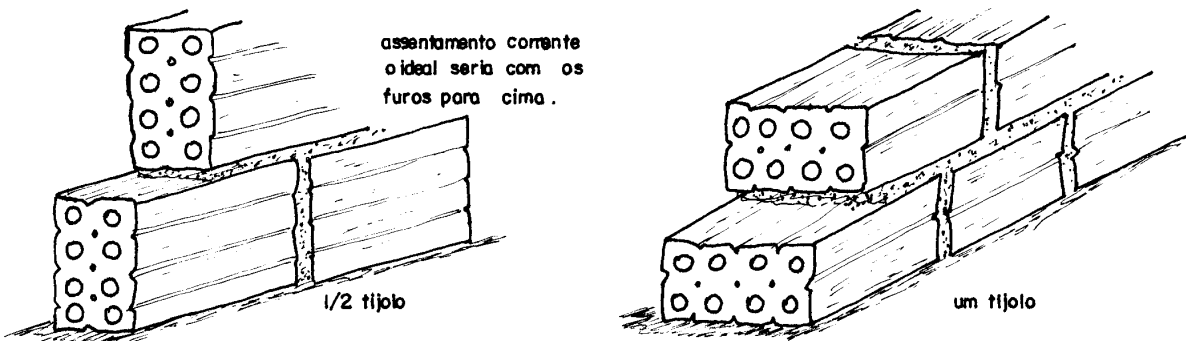
Figura - Execução de alvenaria utilizando tijolos furados
