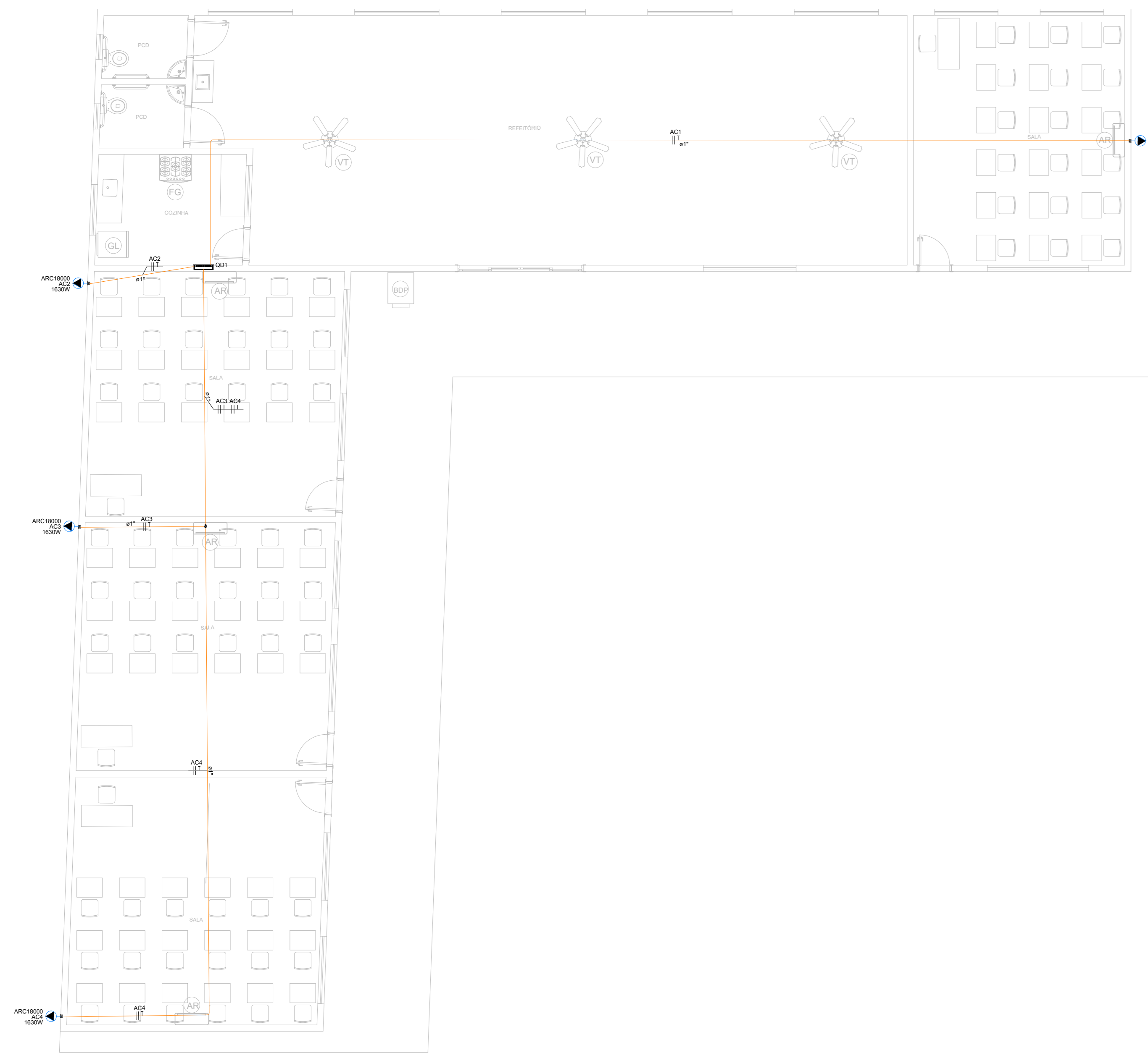
PLANTA BAIXA REFEITÓRIO E SALAS - AR-CONDICIONADO ESCALA: 1/75
