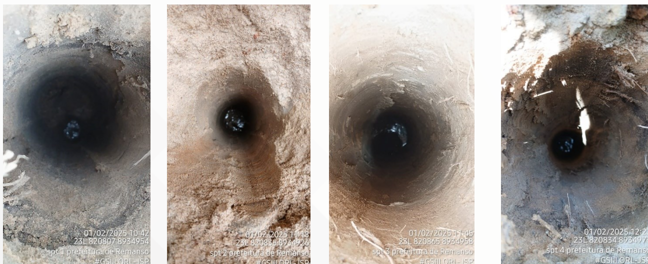
Figura 3: Leitura de N.A. realizado nos furos SP-1 a SP-4.
