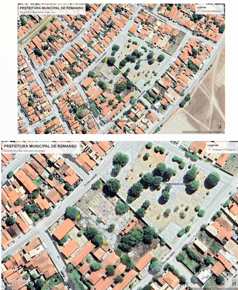
Figura 1: Localização dos pontos onde foram realizadas as sondagens percussivas.
