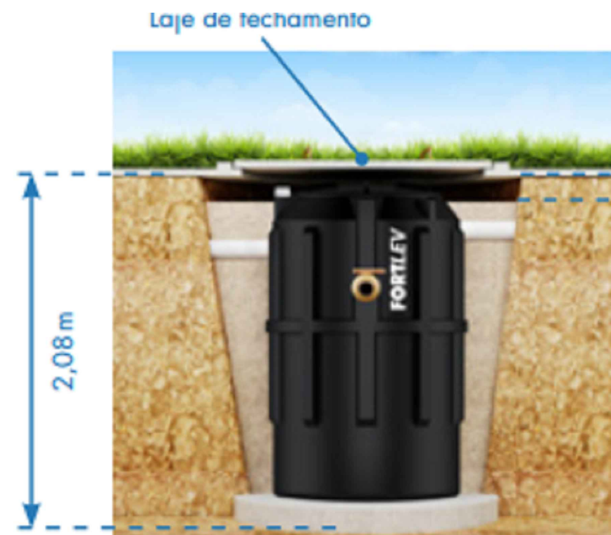
Figura 4 - Instalação com laje de fechamento.
