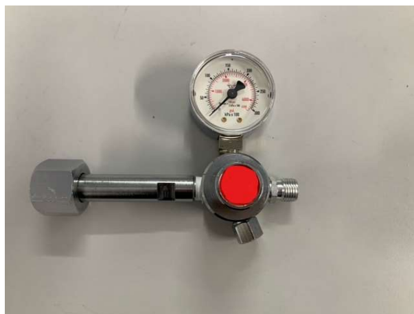
Figura 9 – Válvula redutora de pressão para oxigênio.
