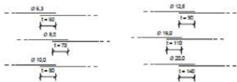
Detalhe da emenda por traspasse Sem escala
