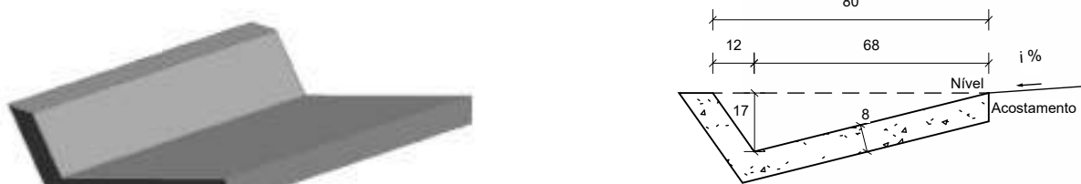
Seção transversal Escala 1 : 20
