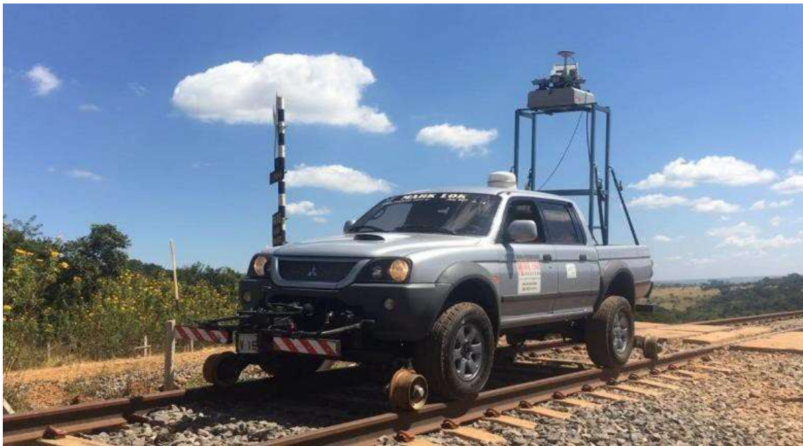
Figura 2 - Equipamento montado em veículo rodoferroviário
