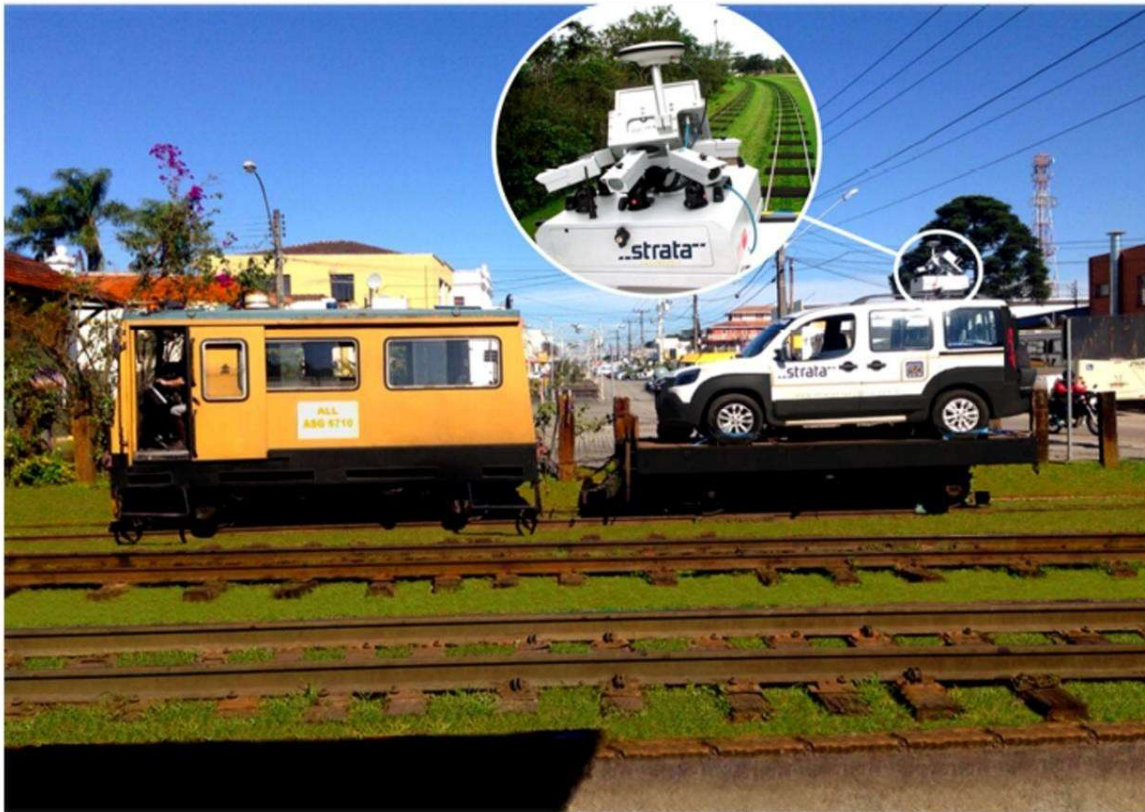
Figura 3 - Equipamento montado em veículo rebocador ferroviário
