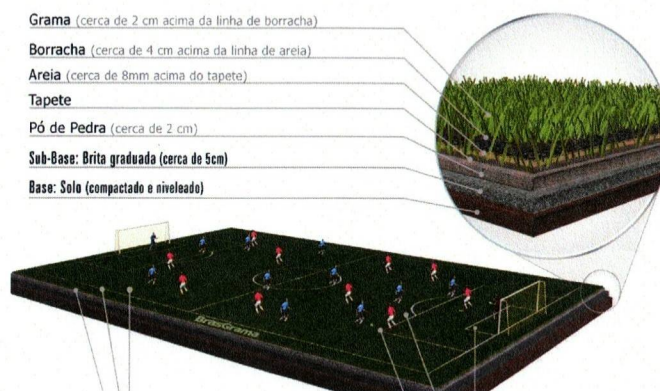
Figura 03 – Detalhe Ilustrativo de Instalação e Revestimento (Grama Sintética)
