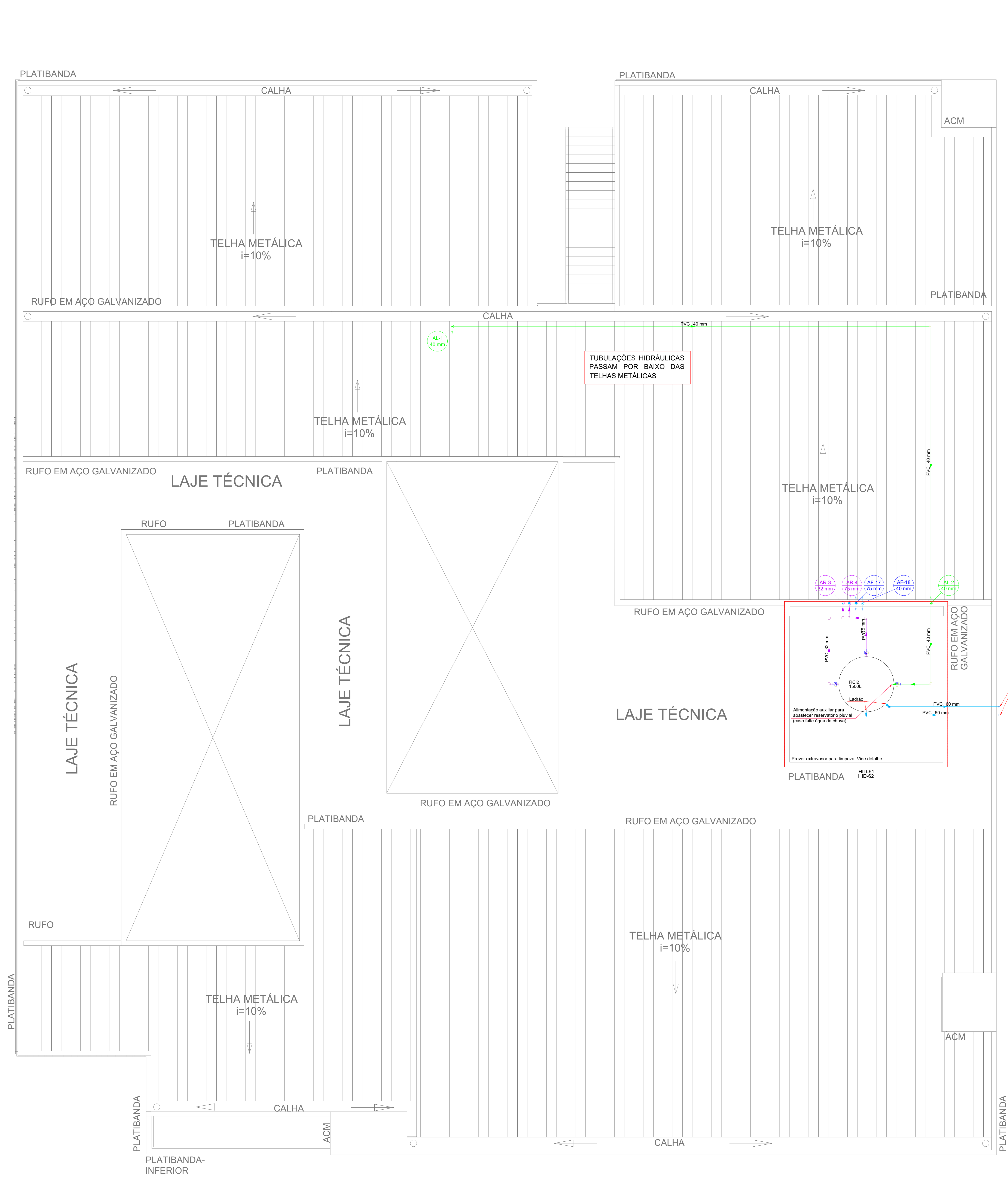
Planta Baixa Cobertura p/ reserv. pluvial Escala 1:50
